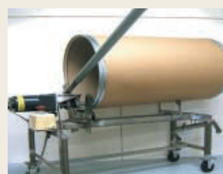
高岡工場 ファイバードラム解体装置
