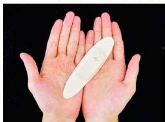
使い切りホルター心電計「EG Holter」
